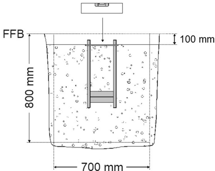
Heben Sie ein Loch mit den Mindestmaßen (L) 700mm, (B) 700mm, (H) 800mm gemäß Zeichnung aus. Die Fundamentgröße richtet sich nach der Bodenbeschaffenheit, weiche oder sandige Böden können größere Fundamente notwendig machen!
