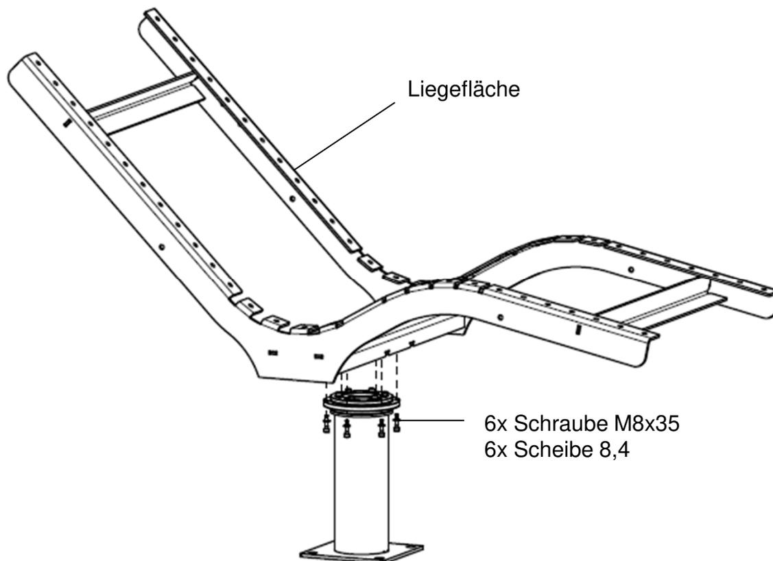
Anziehdrehmoment A2-70 Schrauben: M6 – 6 Nm, M8 – 16 Nm, M10 – 32 Nm. Auf festen Sitz der Verschraubungen achten! Um ein „Fressen“ vom Gewinde zu verhindern, kann eine aufgesprühte PTFE-Trockenschicht verwendet werden.
